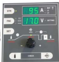
Reglare simplă a parametrilor de sudare pentru versiunile PROCESSOR și SYNERGIC
